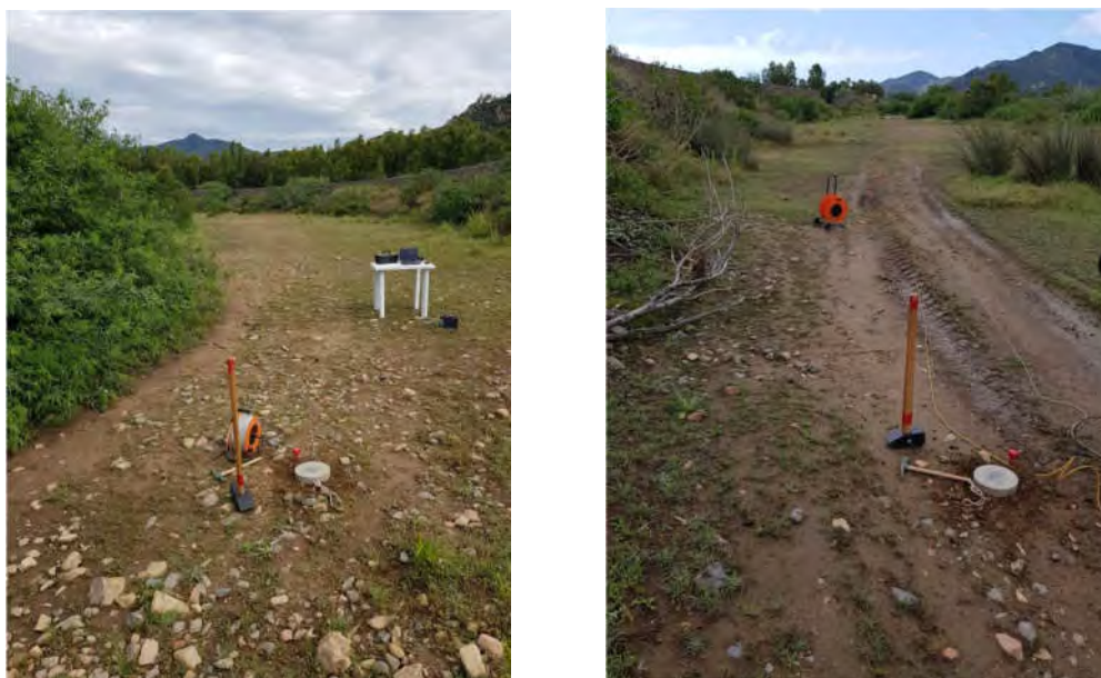
Figura 5 - Allineamento geofonico (diretto a sinistra e inverso a destra).
